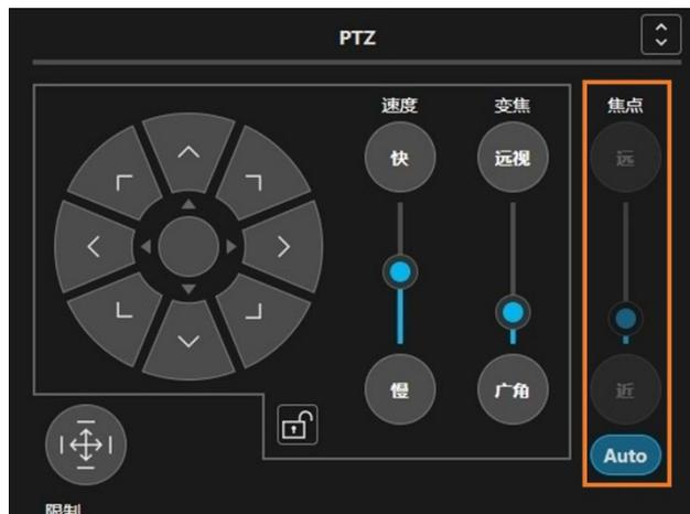
在相机控制器 PTZ 操作栏的对焦栏（上图的线框内）可以调整相机的对焦。单击并拖动滑块的旋钮，或按下[远]/[近]按钮，相机的对焦位置就会变化。单击[Auto]按钮，即可设置相机的自动对焦功能的开/关。
