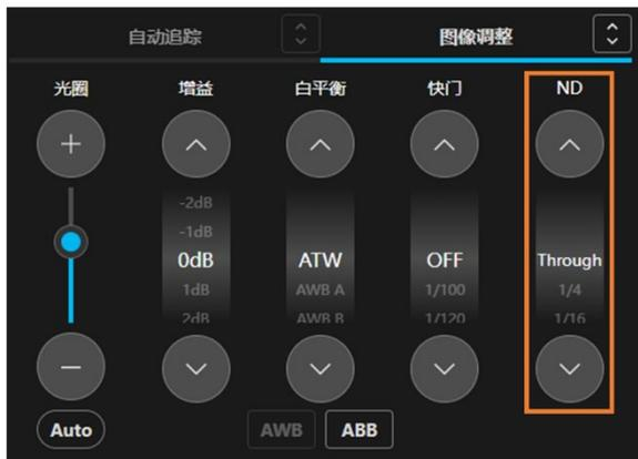
在相机控制器图像调整操作栏的 ND 栏（上图的线框内）可以设置相机的 ND 滤镜。
