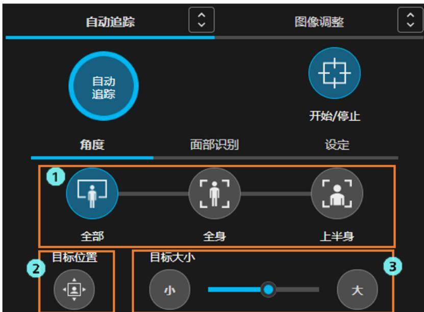
使用相机控制器自动追踪操作栏的[角度]选项卡内的[全部]按钮/[全身]按钮/[上半身]按钮（上图 1），可以设置自动追踪中的相机角度。
