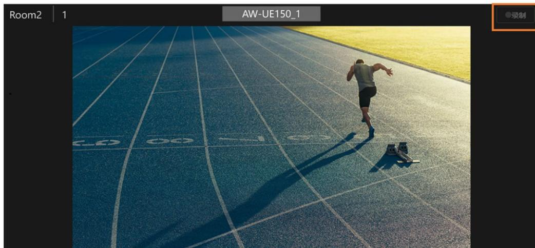
相机支持视频记录功能时，单击相机视频区内的[录制]按钮(上图的线框内)，执行视频记录开始操作/停止操作。
