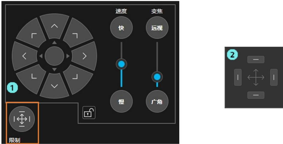
单击 PTZ 操作栏的[限制]按钮（上图 1），即会显示平移/俯仰的可动范围的设置面板（上图 2）。
