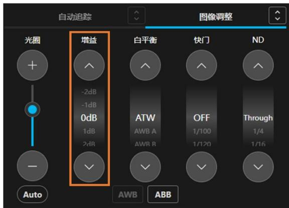
在相机控制器图像调整操作栏的增益栏（上图的线框内）可以设置相机的增益。
