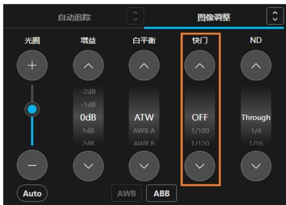
在相机控制器图像调整操作栏的快门栏（上图的线框内）可以设置相机的快门模式。单击向上箭头/向下箭头按钮，设置值就会发生变化。单击设置值的显示部分，即会显示可设置的设置值列表，也可以从此处直接选择设置值。
