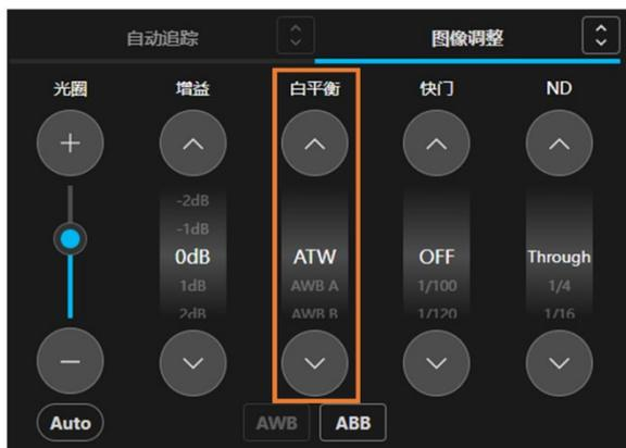
在相机控制器图像调整操作栏的白平衡栏（上图的线框内）可以设置相机的白平衡模式。
