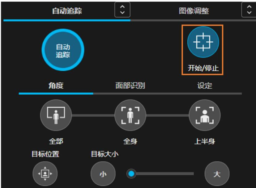
使用相机控制器自动追踪操作栏的[开始/停止]按钮（上图的线框内），可以开始/停止利用自动追踪移动相机。
