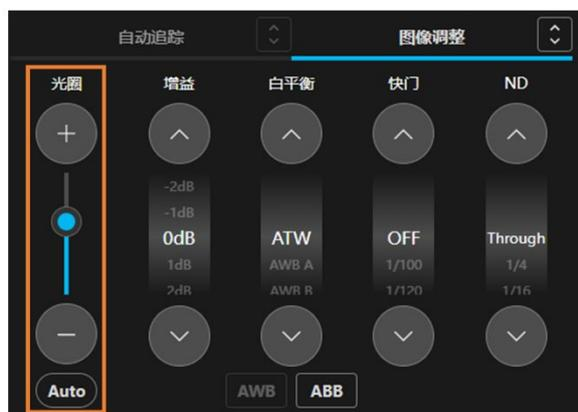
在相机控制器图像调整操作栏的光圈栏（上图的线框内）可以调整相机的光圈。单击并拖动滑块的旋钮，或按下[+]/[-]按钮，相机的光圈位置就会变化。单击[Auto]按钮，即可设置相机的自动光圈功能的开/关。
