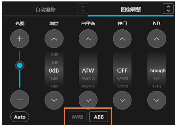
单击相机控制器图像调整操作栏的[AWB]按钮，即会在相机端执行 AWB。单击[ABB]按钮，即会在相机端执行 ABB。
